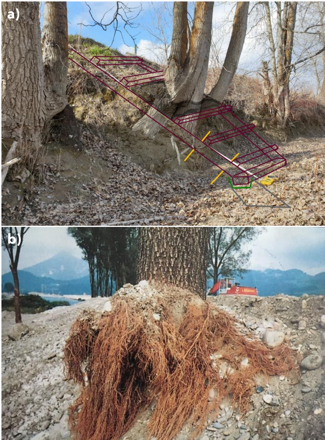
Figure 16 a) Schéma illustrant la position du treillage-bois autour des arbres matures pour les conserver sur le site (développement d'approches, projet en Colombie-Britannique) ©Terra Erosion Control Ltd. b) Illustration des racines développées par un saule arborescent enterré après une année avec remblai (Schiechl, H.M. et R. Stern. 1997).
