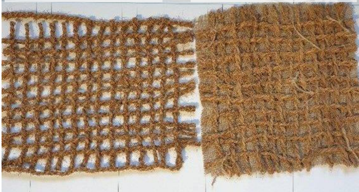
Coco tissé de 740 g/m 2 et coco non tissé jute de 270 g/m 2
